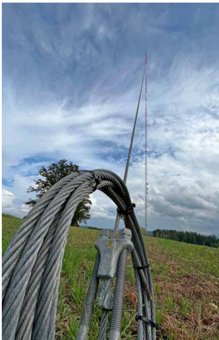
Fest im Boden verankert: Eine der beiden Windkraft-Messanlage auf der Äberdingerhöchi. Foto Stefan Bossart
