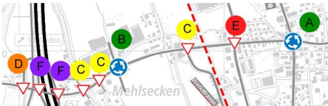
Abbildung 45: Knotenleistungsfähigkeiten Pfaffnauerstrasse, ASP 2020, Infrastruktur Bestand
