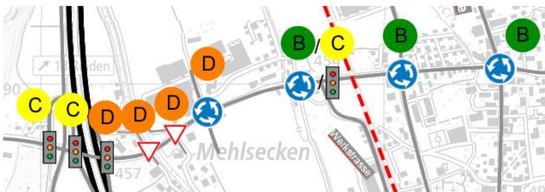
Abbildung 61: Knotenleistungsfähigkeiten Pfaffnauerstrasse, ASP 2040 Sz2, Infrastruktur Massnahmenzustand
